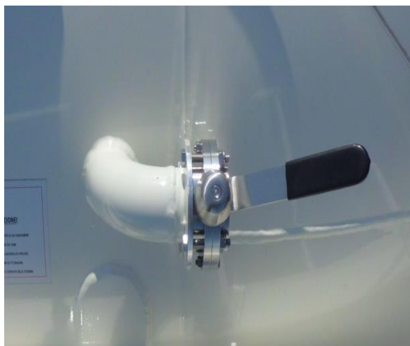
COUDE ALU Ø 60 POUR PIQUAGE DECOMPRESSION CUVE SK
