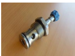
ELECTROVANNE POUR LA DESCENTE RAPIDE DU VERIN (CLE DE SERRAGE 38 mm)
