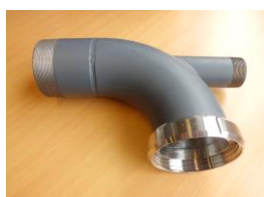
COUDE DE DEPOTAGE ACIER DN 100 – SMS 104 EPAISSEUR 6,3 mm.
